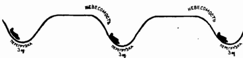
*Схема траектории полета аэрофуги
