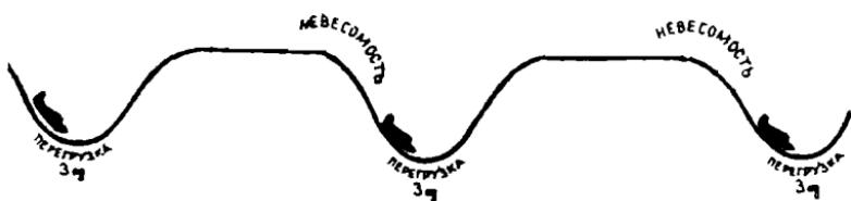
Рис. 10. Приблизительная схема траектории полета аэрофуги с участками горизонтального и параболического полетов и отрезками перегрузки и невесомости
